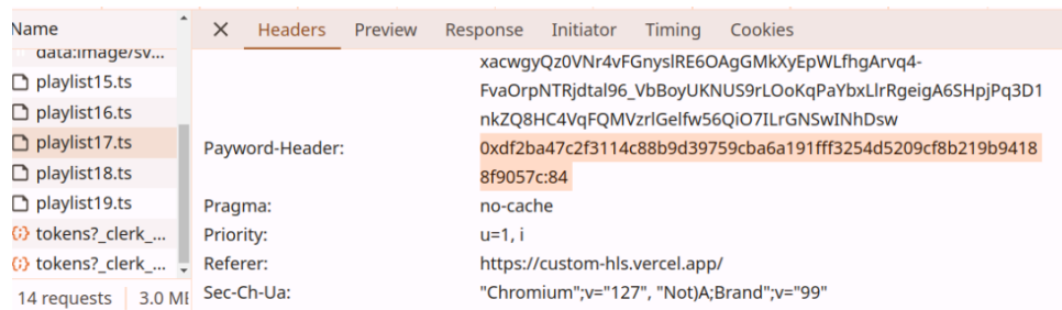
Figura 7 – Estrutura da requisição HTTP para segmentos de vídeo com token de micropagamento
