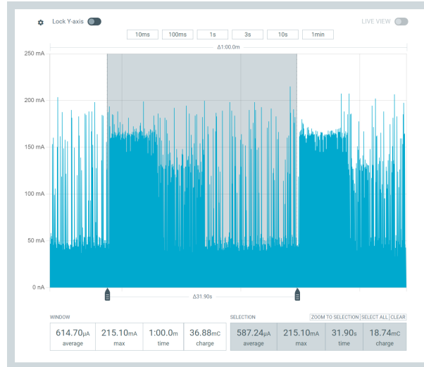
Figura 39 – Gráfico gerado do osciloscópio do Power Profiling Kit II da Nordic durante o teste de consumo de energia do firmware na Pulga
