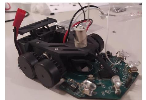
Além disso as engrenagens foram manufaturadas com impressão 3D, oferecendo uma solução leve, customizada e eficiente para a transmissão de movimento.
