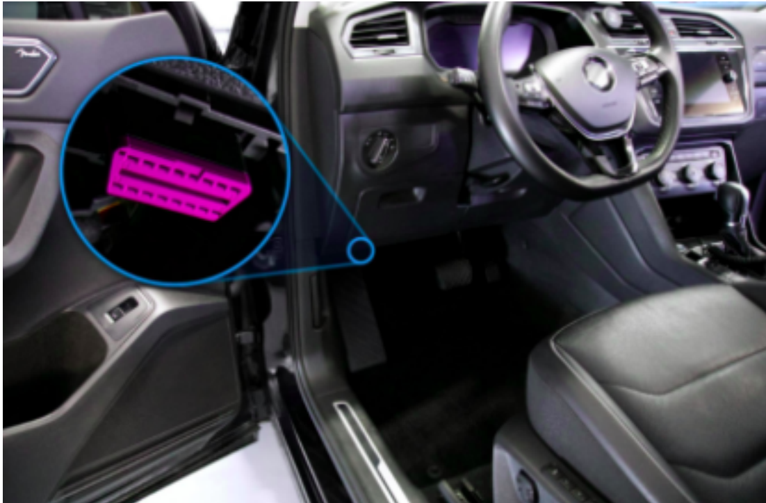
Figura 2: Posição da porta OBD-II em um carro [5]
