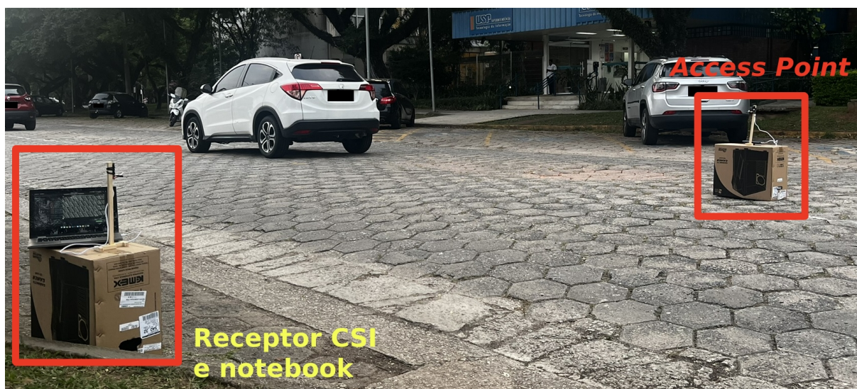
Figura 35 – Setup para coleta de dados em ambiente urbano, em frente ao prédio onde está localizado o Departamento de Engenharia de Computação e Sistemas Digitais (PCS) da Poli-USP. À esquerda, vê-se o receptor CSI, responsável pela coleta das medições CSI, e o notebook para onde os dados são exportados via saída serial. À direita, vê-se o access point WiFi, ao qual o receptor se conecta.
