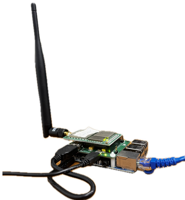
Figura 23 – Gateway configurado, constituído de um Raspberry Pi 3 Model B+ e HAT LoRa RHF0M301.
