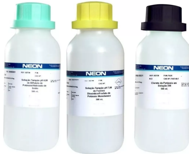
Figura 12 – Soluções de calibração pH = 4 e pH = 7 e solução de cloreto de potássio
