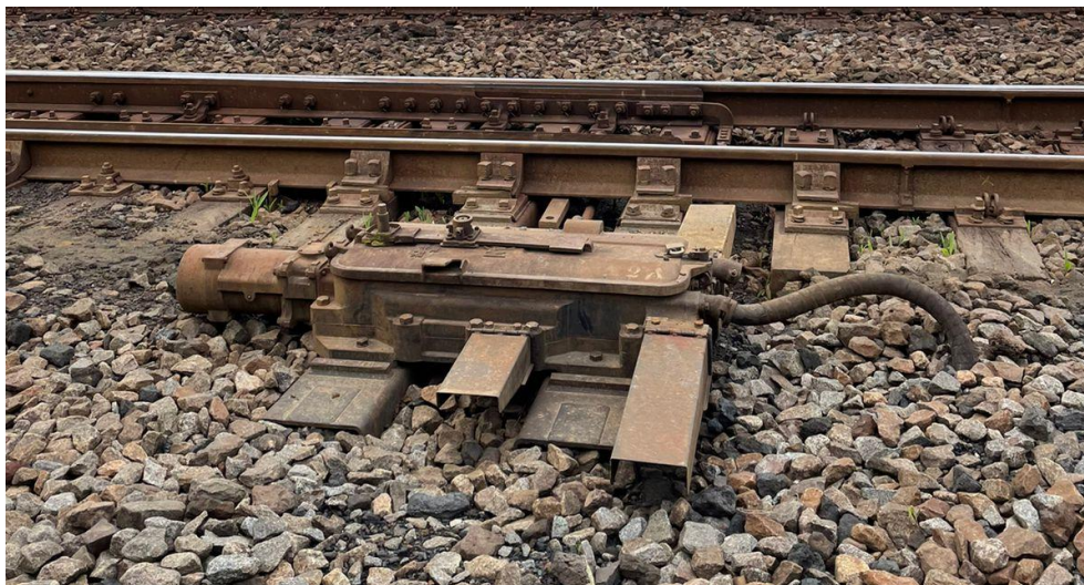
Figura 2. Máquina de chaves KY e sua aplicação na ferrovia.
