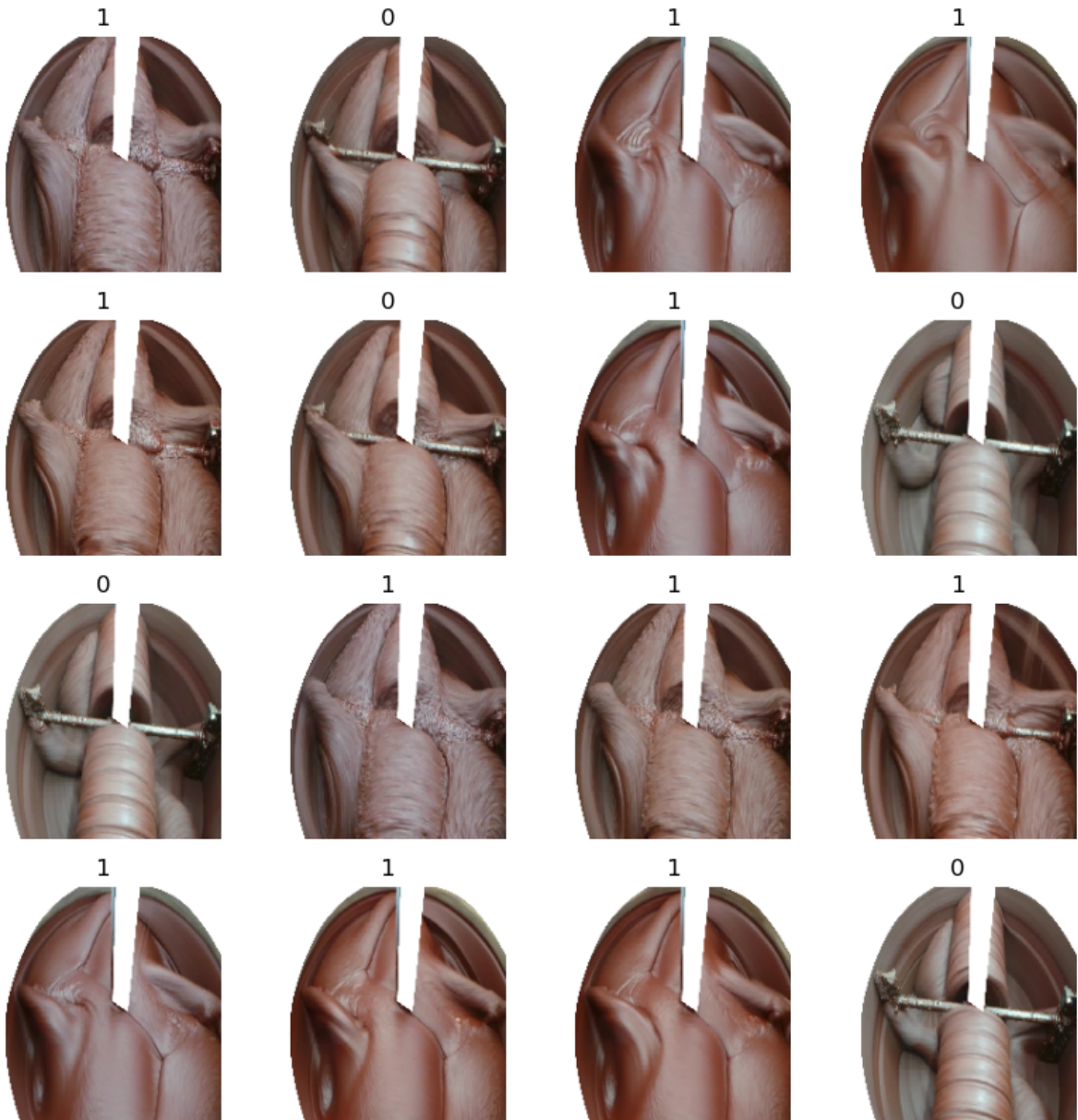
Figura 22: Plot das imagens que compõem o dataset de treinamento acompanhadas de suas respectivas classes. 0 Representa as massas que devem ser inferidas como não prontas e 1 as massas que devem ser inferidas como prontas.
