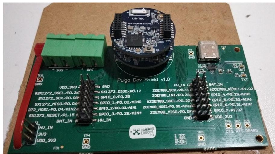
Figura 15: Stack formado pela Pulga core e pela Pulga LoRa
