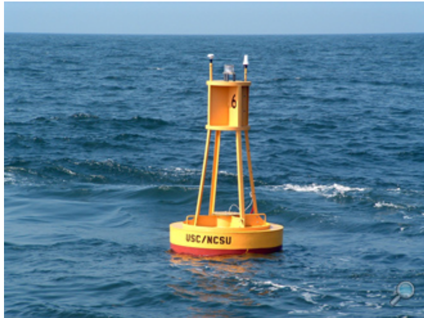
Figura 1: Exemplo de uma boia projetada para uso como plataforma de instrumentação meteorológica e oceanográfica.
