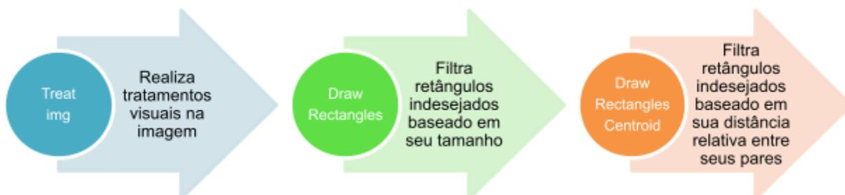
Figura 23: Esquema de funcionamento dos macroprocessos do modelo de identificação das faixas de pedestres
