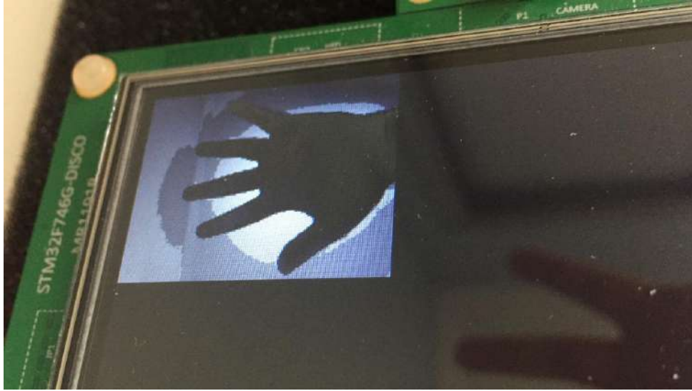
Figura 25: Imagem em escala de cinza capturada pelo sensor de imagem.
