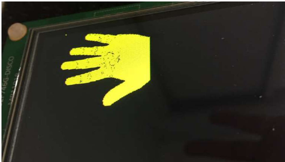
Figura 26: Imagem binarizada através do algoritmo de Otsu, exibindo “Pepper noise”
