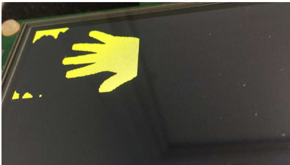
Figura 28: Resultado da aplicação de uma operação de dilatação sobre a saída do algoritmo de Otsu.
