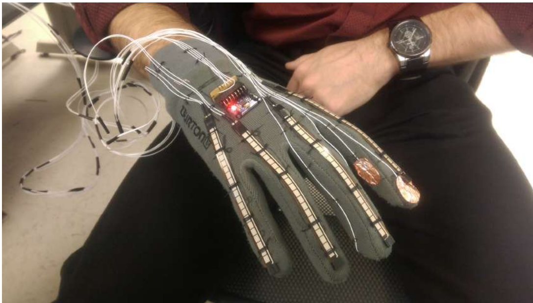
Figura 4: Exemplo de uma luva com sensores utilizada para a IHC através de gestos.
