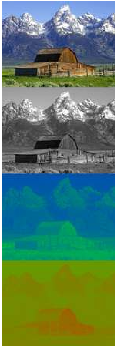
Figura 22: De cima para baixo: uma imagem colorida, sua componente Y, sua componente U e sua componente V.
