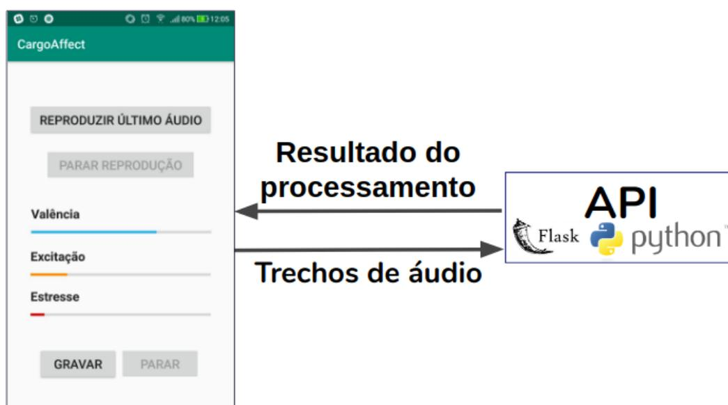
Fig. 3 – Esquema ilustrativo do funcionamento do sistema
