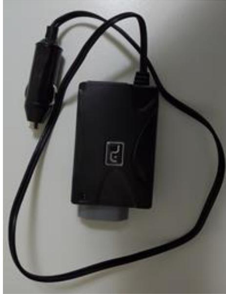
Figura 18 - Inversor/transformador utilizado para alimentação do *hardware* no carro. Fonte: autores
