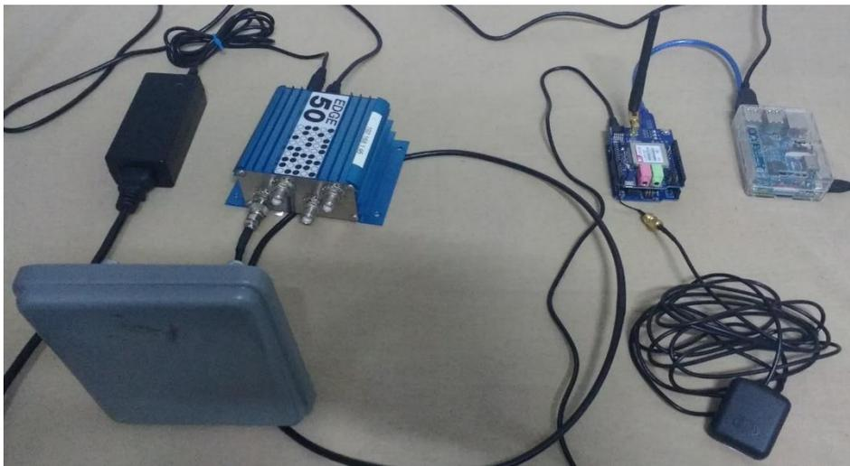
Figura 19 - Montagem para testes; da esquerda para a direita: leitora RFID e antena, *Arduino* com módulo SIM5230E e antenas, *Raspberry Pi*. Fonte: autores
