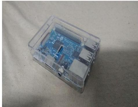
Figura 13 - Placa *Raspberry Pi 3 Model B*. Fonte autores
