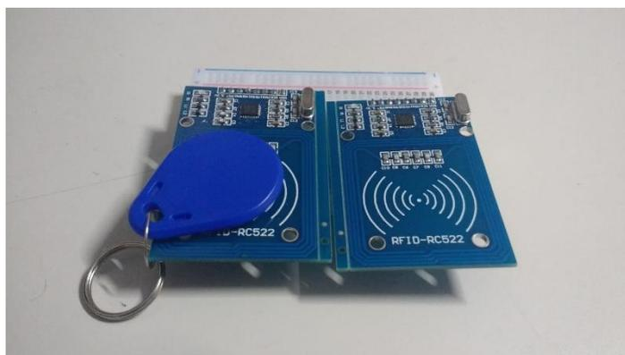
Figura 9 - Leitoras RFID *Mfrc522 Mifare* com *tag*. Fonte: autores
