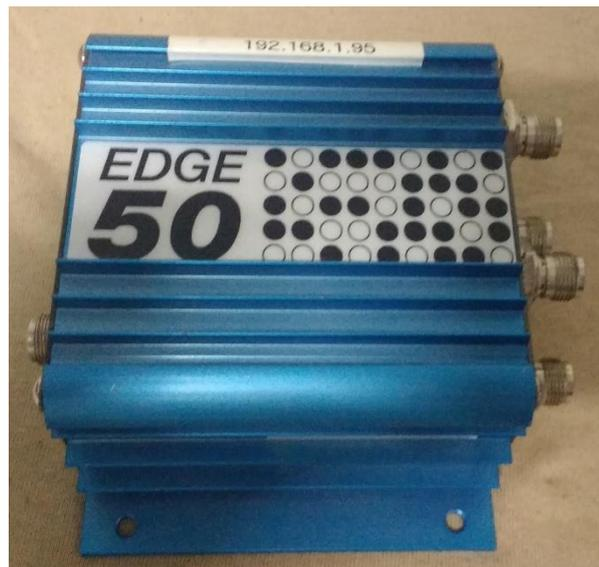
Figura 10 - Leitora RFID *Acura Global Edge-50*. Fonte: autores
