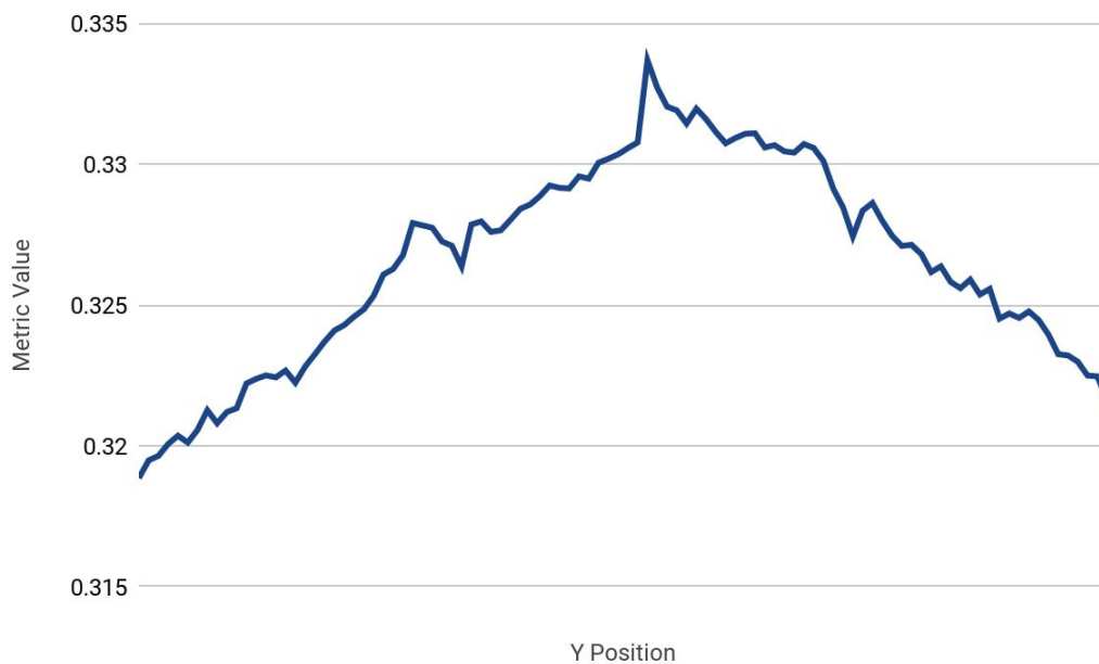
Figura 10: O gráfico mostra a variação do valor da métrica à medida que o robô caminha ao longo do eixo Y e passa seu valor real com um passo de 0,05 milímetros por amostra.
