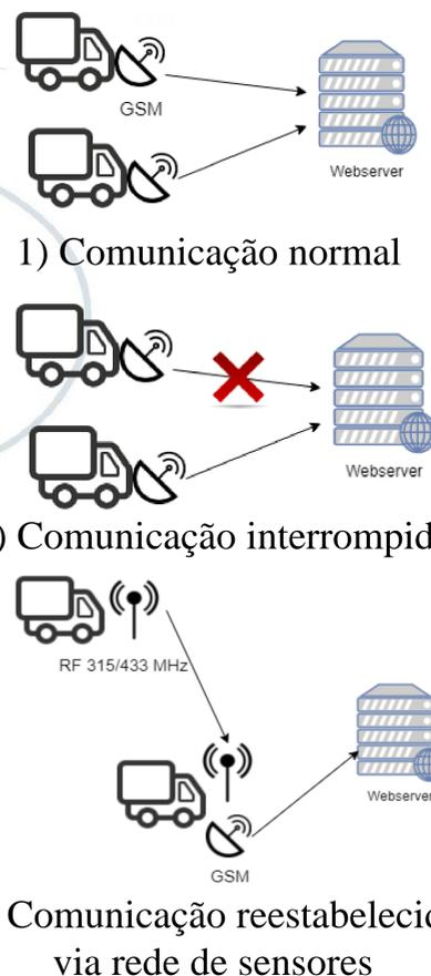
Figura 2 – Rede de sensores entre veículos monitorados
