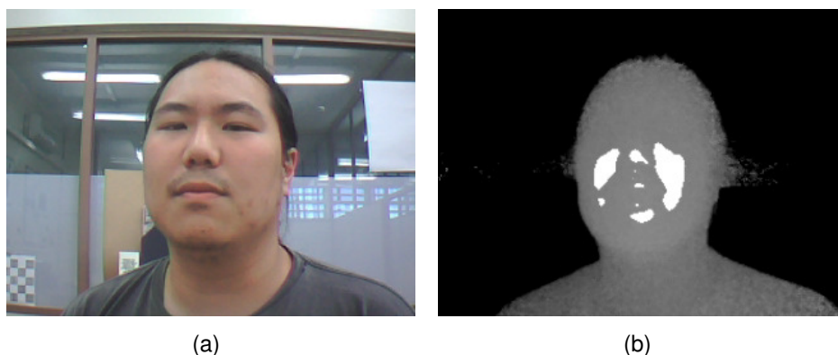
Figura 5 – Mapa de Profundidade obtido por meio de sensor do tipo TOF ( Time-of-Flight ) (IDDAN; YAHAV, 2001). Em (a) e (b) são mostrados o quadro de vídeo e o mapa de profundidade do mesmo quadro, respectivamente. Os pixels mais claros representam os mais próximos da câmera de vídeo (e do sensor) ao passo que os mais escuros são os mais distantes (SANCHES et al., 2012)
